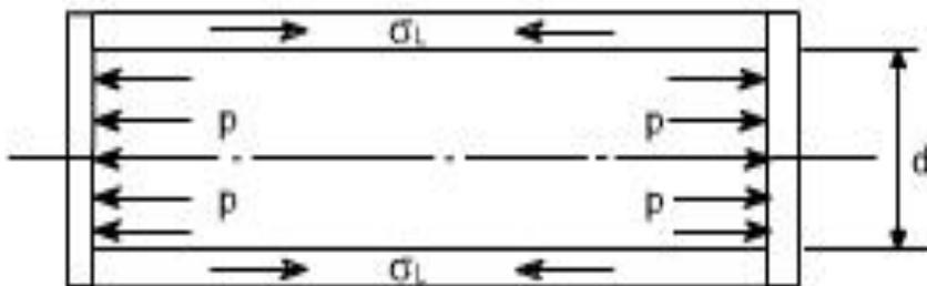
Fig. Longitudinal Stress
